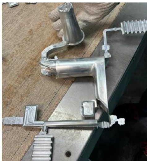
Слика 8 – Изглед одливка након ливења
