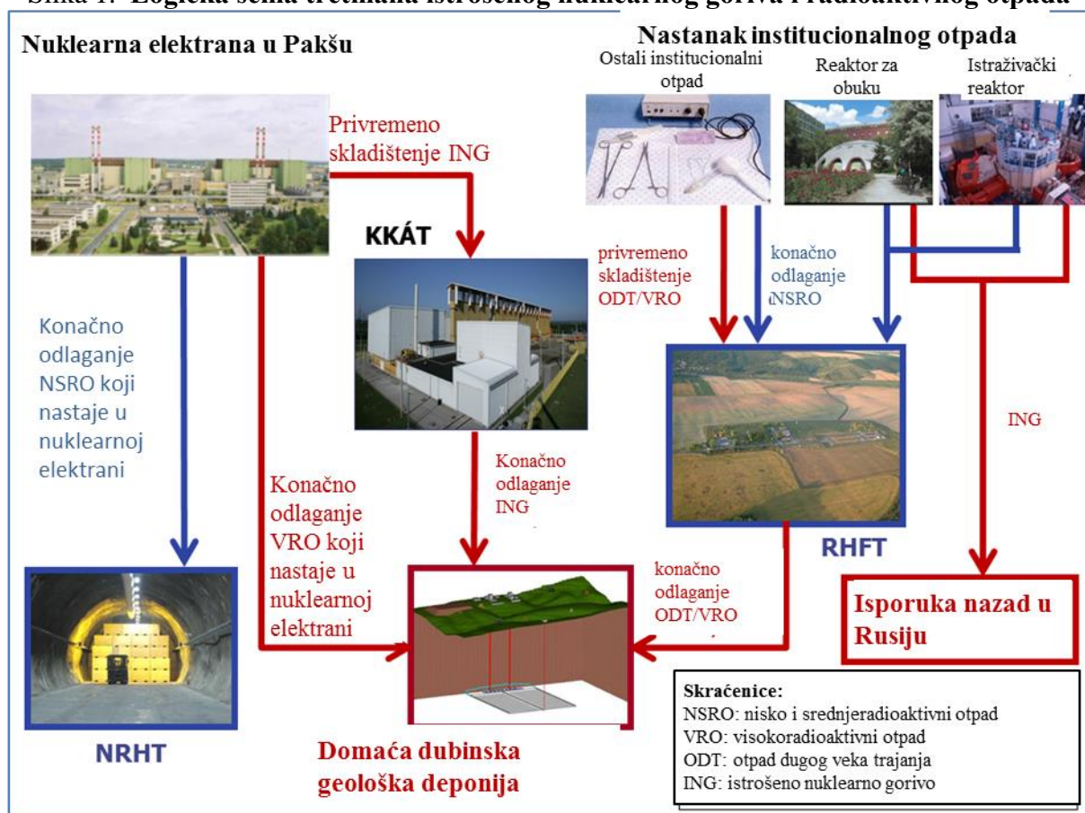
Slika 1. Logička šema tretmana istrošenog nuklearnog goriva i radioaktivnog otpada
