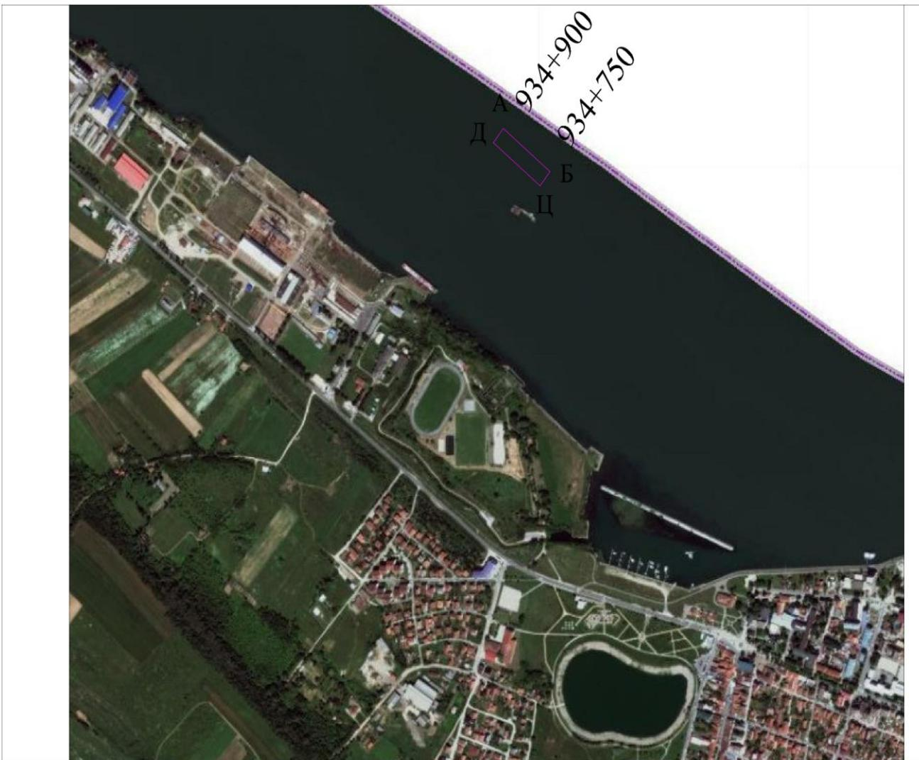
Posmatrani potez u koritu reke Dunav dužine 150 m, predstavlja potencijalno pozajmište rečnog nanosa. Bagerovanje sa njega mora biti kontrolisano, vodeći računa o režimu tečenja, kao i postojećim i planiranim hidrotehničkim i drugim objektima. Obzirom da se predviđeno eksplotaciono polje nalazi u sektoru nepovoljno za plovidbu pri niskim vodostajima, eksplotacijom će se poboljšati uslovi plovidbe na ovom sektoru i uslovi prirodnog oticanja i pronosa vučenog nanosa.
