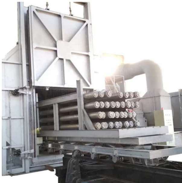
Slika 21: Operacije unošenja/iznošenja trupaca iz peći za homogenizaciju
