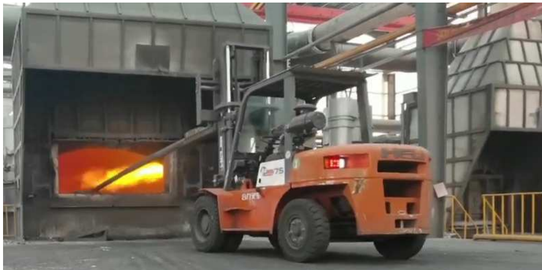
Slika 9: Mešanje rastopa u peći
