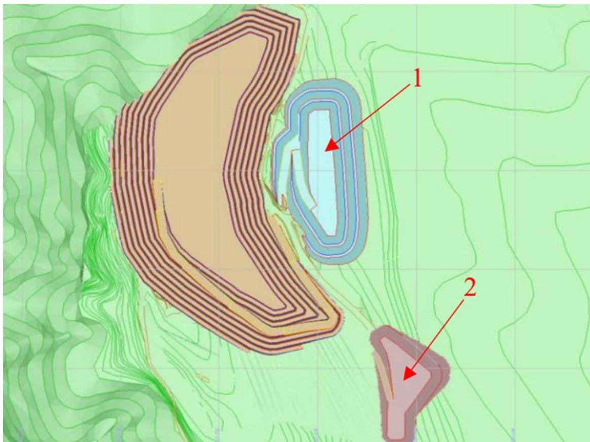
Slika 2. Konačna konstrukcija površinskog kopa Zagrađe-5, odlagališta jalovine i ozajmišta zemljanog materijala (1. odlagalište jalovine, 2 odlagalište zemljanog materijala)
