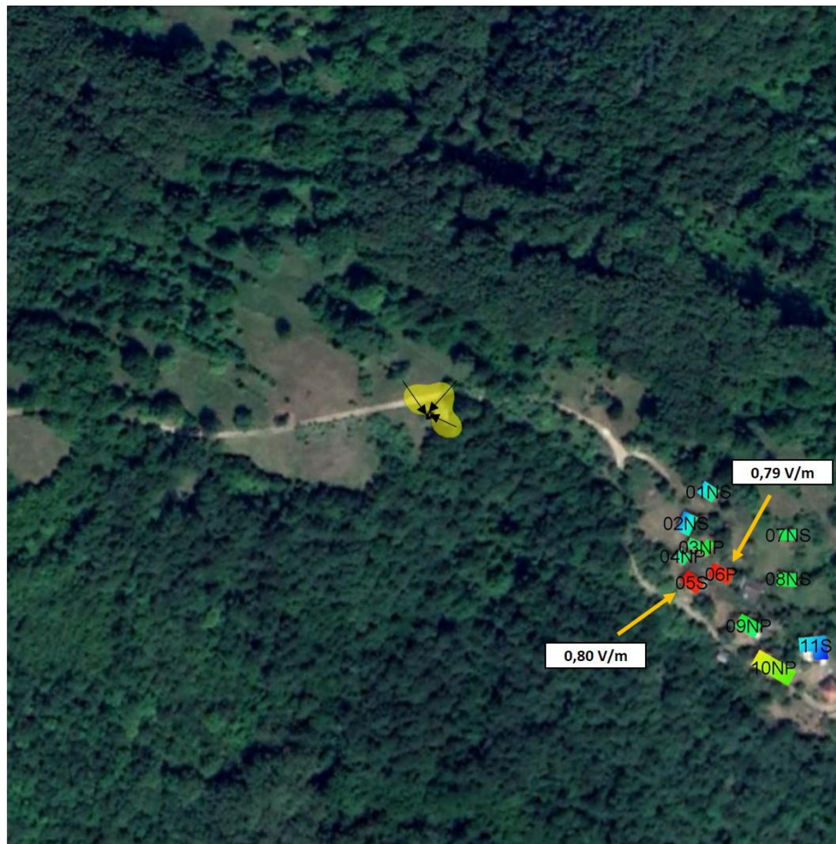
Слика 4.10. Јачина електричног поља унутар објеката када систем LTE800 оператора Телеком Србија ради максималним капацитетом
