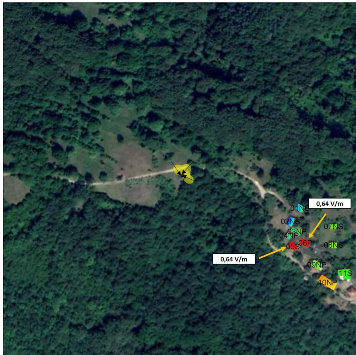
Слика 4.8. Јачина електричног поља унутар објекта када систем GSM900 оператора Телеком Србија ради максималним капацитетом
