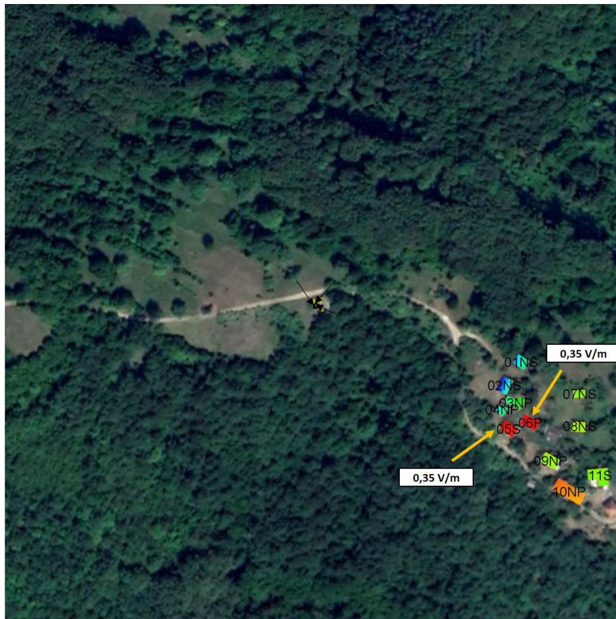
Слика 4.9. Јачина електричног поља унутар објекта када систем UMTS2100 оператора Телеком Србија ради максималним капацитетом
