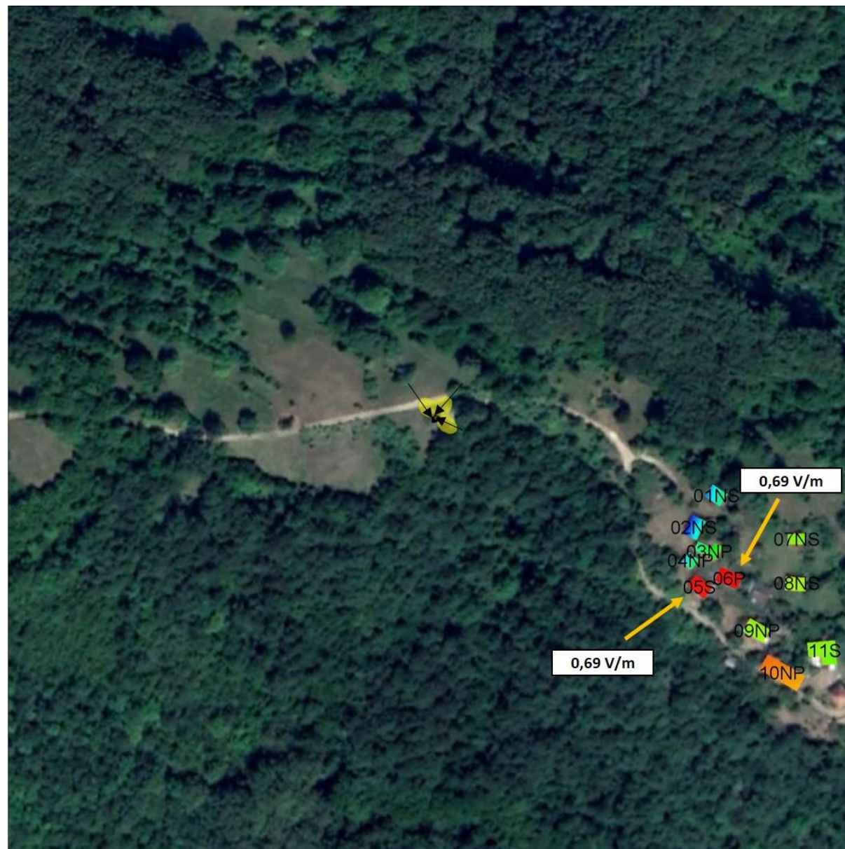
Слика 4.12. Јачина електричног поља унутар објекта када систем LTE2100 оператора Телеком Србија ради максималним капацитетом
