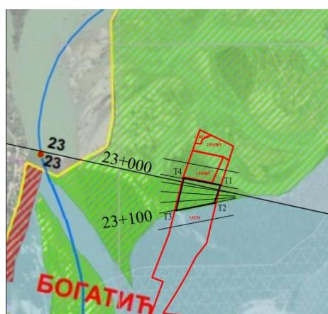
Posmatrani potez u koritu reke Drine dužine 100 m. površine 9.277,50 m<sup>2</sup>, predstavlja potencijalno pozajmište rečnog nanosa. Bagerovanje sa njega mora biti kontrolisano, vodeći računa o režimu tečenja, kao i postojećim i planiranim hidrotehničkim i drugim objektima. Obzirom da se predviđeno eksploraciono polje nalazi u sektoru nepovoljno za plovidbu eksploracijom će se poboljšati uslovi prirodnog oticanja i pronosa vučenog nanosa.
