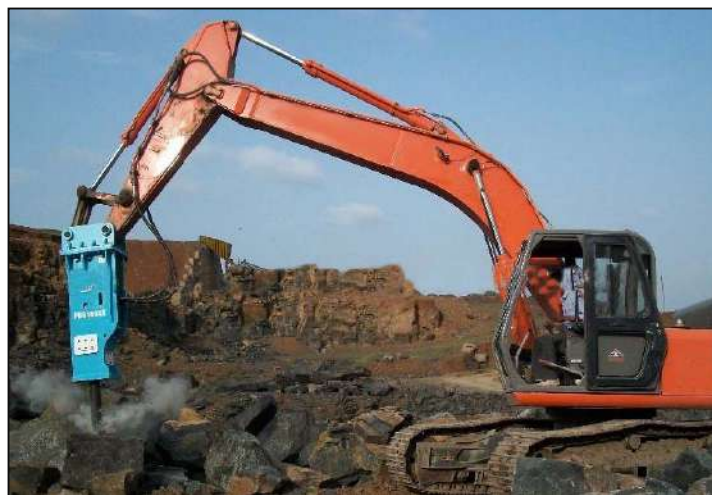
Слика 9. – Уситњавање негабарита механичким ударним чекићем
