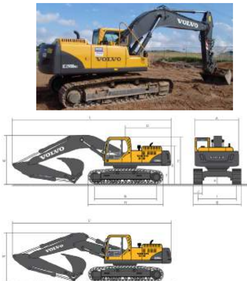
Слика 19: Димензије багера Volvo 290 BNLC
