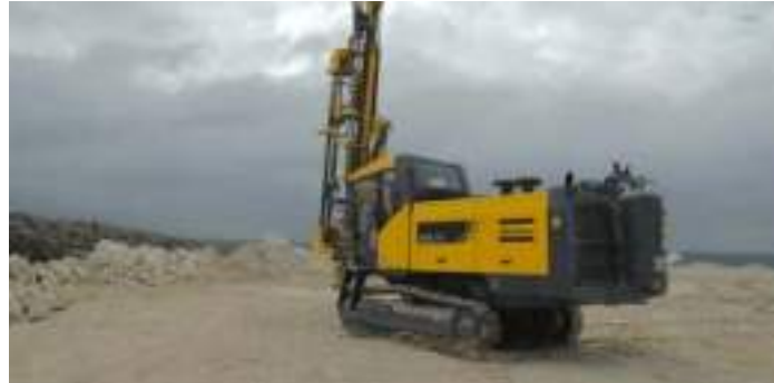
Слика 18: Техничке карактеристике бушилице Atlas Copco ROC F6
