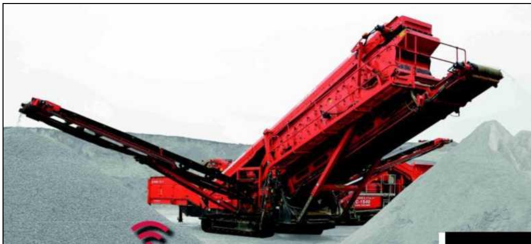
Слика 22. - Мобилно сито FINLAY TEREX 694 SUPERTRAK
