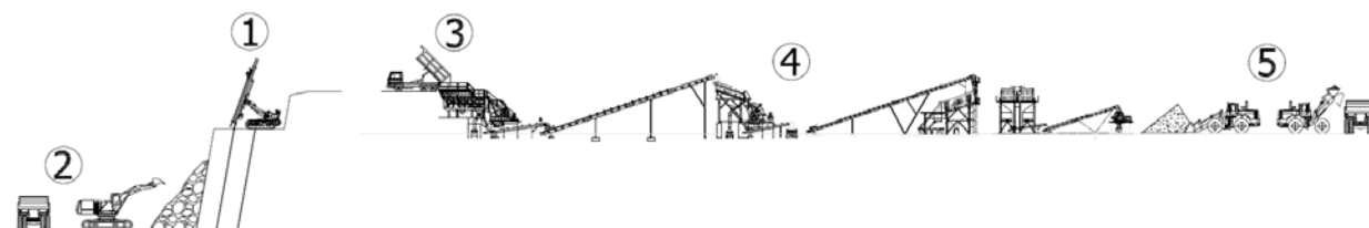
Slika 2.1. Tehnološki presek sistema eksploatacije krečnjaka (1) bušenje minskih bušotina, punjenje eksplozivima i miniranje; (2) utovar odminiranog materijala hidrauličnim bagerom u kamion; (3) transport odminiranog materijala u prihvatni bunker stabilnog postrojenja; (4) stabilno drobilno postrojenje; (5) utovar gotovih proizvoda utovarivačem u kamione kupaca
