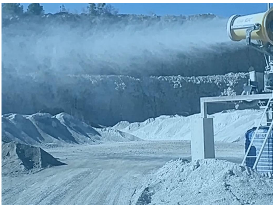
Слика бр.8: Специјализовани систем "Envex" у функцији обарања прашине на површинском копу водом и компримованим ваздухом
