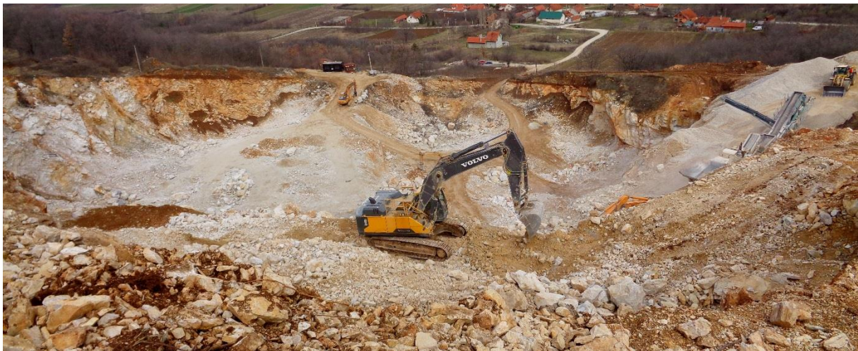
Слика бр.5: Панорама површинског копа "Виногради" са заштитним бредом и експлоатационим етажама
