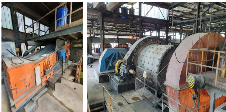
Слика 23 и 23.1: извори буке, вибро-сито и млин
