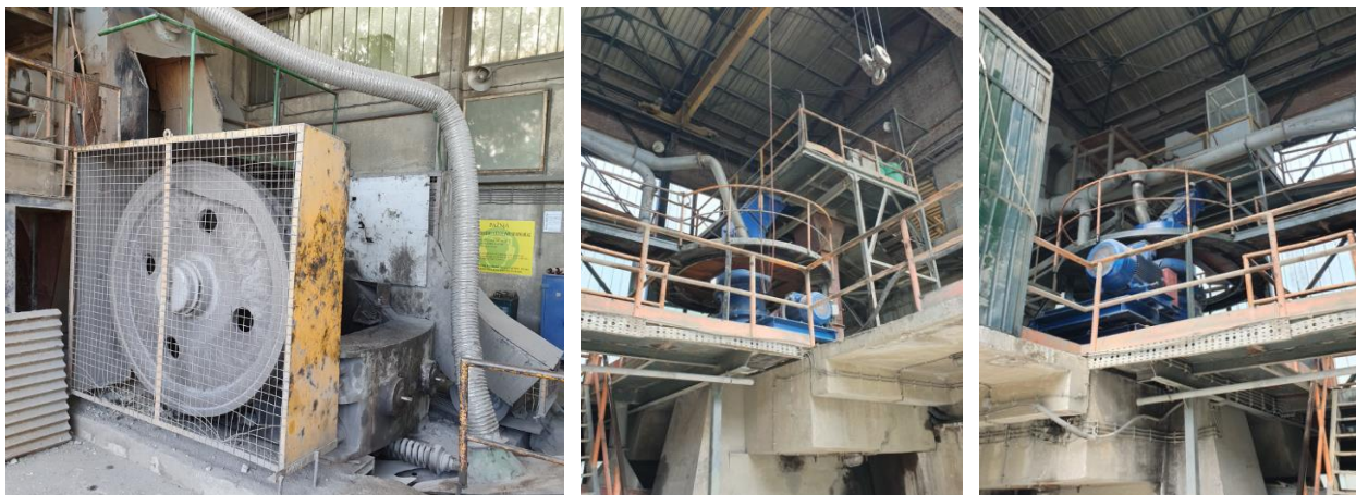
Слика 22, 22.1 и 22.2: извори буке, примарна, секундарна и терцијална дробилица
