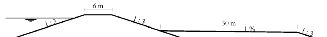
Слика 3.1 – Карактеристичан попречни пресек савског насипа на предметном потезу
