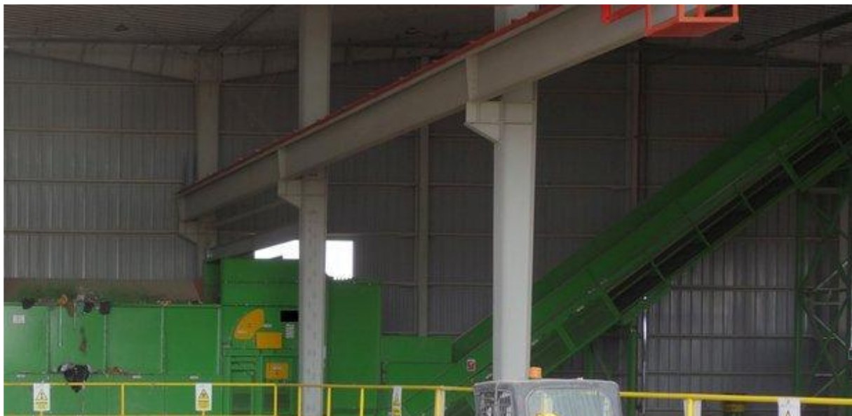
Слика бр.16: Приказ Отварача кеса и транспортне траке до кабине за сортирање
