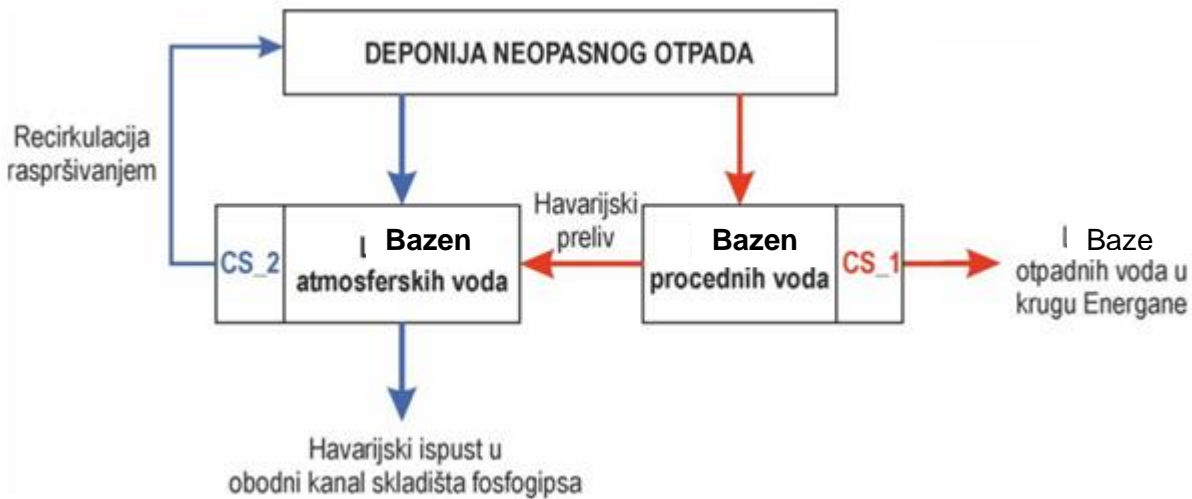
Slika 23 Shematski prikaz toka voda (procednih i atmosferskih) na deponiji neopasnog otpada
