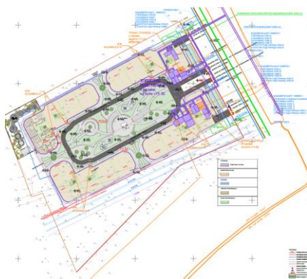
ИДР-регулационо-нивелационо решење са основом приземља и приказом саобраћајног решења
