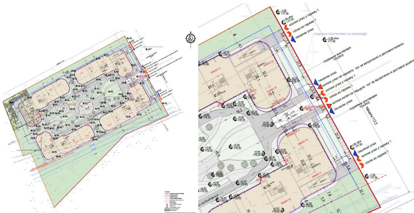
ИДР-регулационо-нивелационо решење са основом приземља и приказом саобраћајног решења
