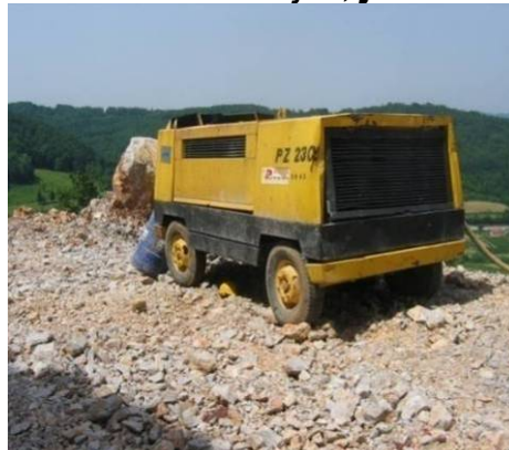
Slika 1. Samohodna bušilica sa dubinskim čekićem i kompresor
