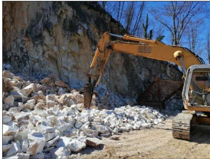
Слика 15. – Пример уситњавања негабарита механичким ударним чекићем
