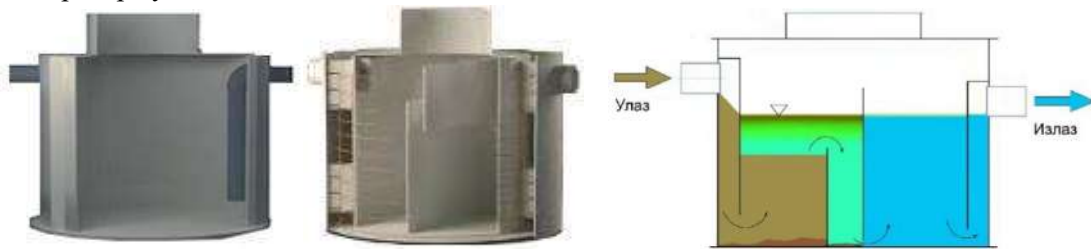
Слика 13. – Изглед и попречни пресек и принцип рада сепаратора масти и уља
