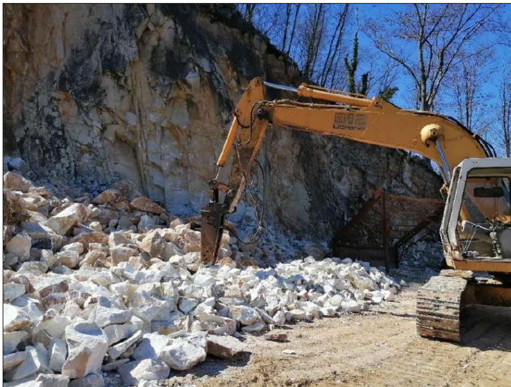
Слика 22. – Уситњавање механичким ударним чекићем
