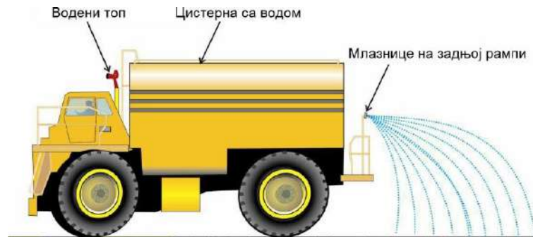
Слика 25. – Аутоцистерна опремљена пумпом, предњим топом и задњом рампом са млазницама
