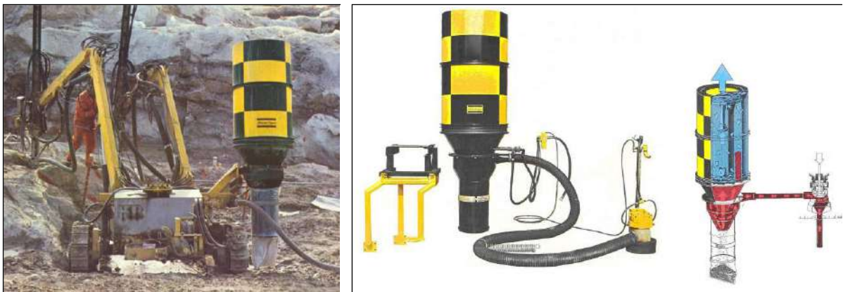
Слика 24. – Отпрашивач DCD 90 са филтером и сувим циклоном у раду
