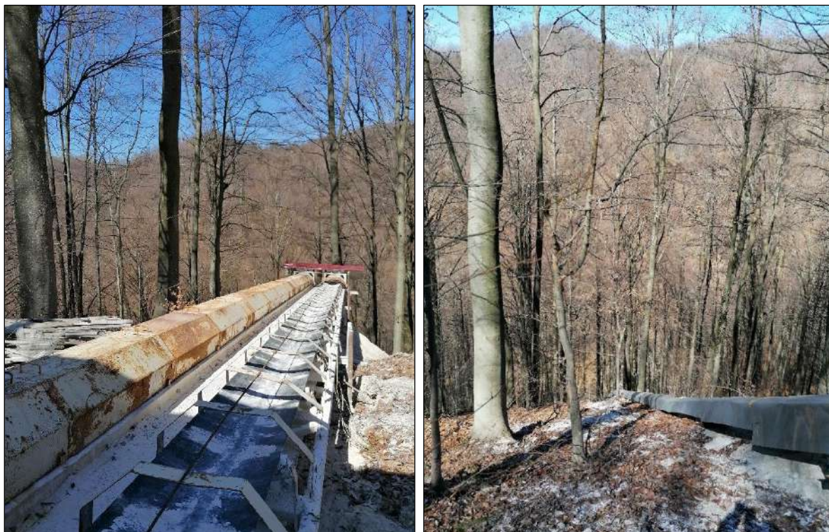
Слика 18. – Транспортне траке (лево) и склизница за транспорт готовог производа (десно)
