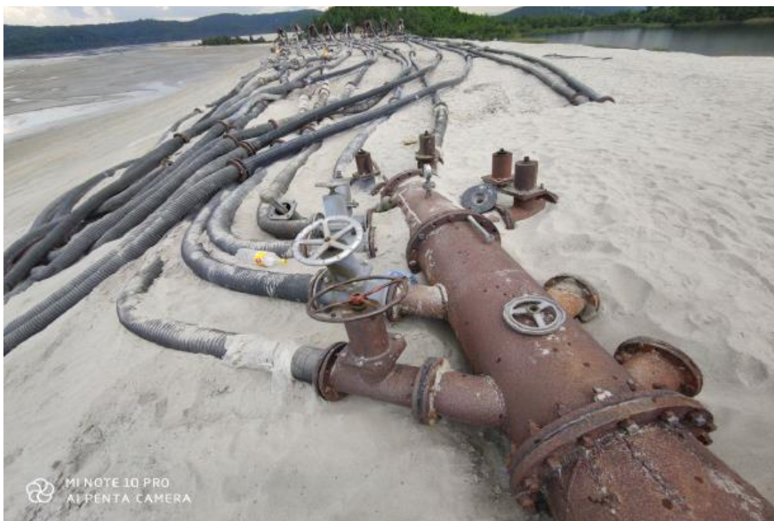
Слика 4.26. Начин повезивања ХЦ на дистрибутере пулпе на флотацијском јаловишту „Ваља Фундата“, снимљено јуна 2020. године
