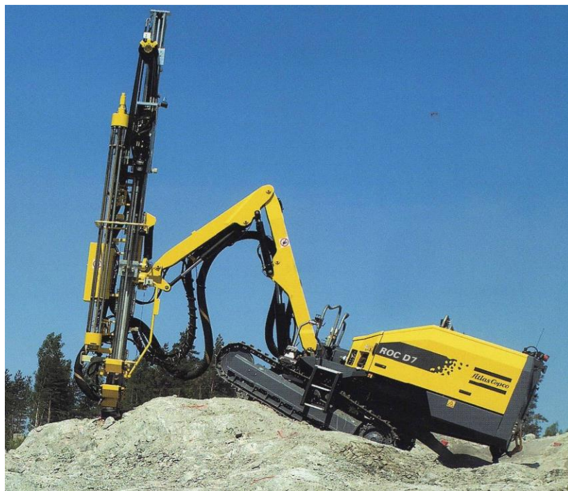
Slika 3-5. Bušilica Atlas Copco ROC D7
