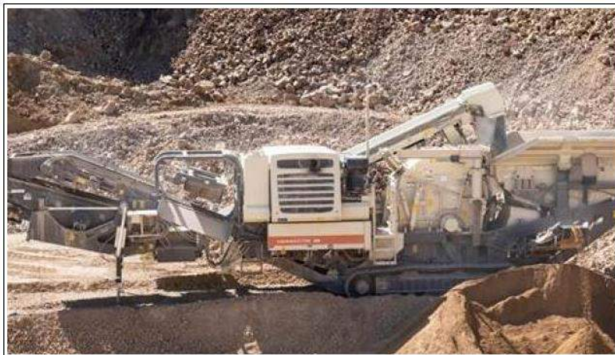
Слика бр. 19: Мобилно дробилично постројење METSO MINERALS LT 1110
