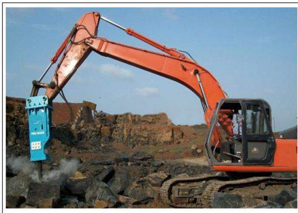
Слика бр. 17: Уситњавање негабарита механичким ударним чекићем
