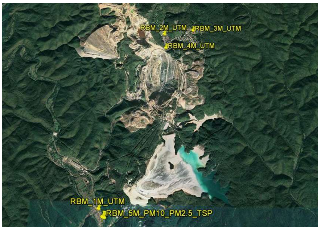
Slika 6.14 - Položaj mernih mesta na kojima se vrši ispitivanje kvaliteta vazduha
