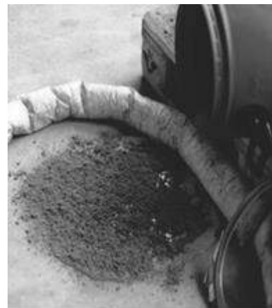
Слика 7.1 Целулозне тканине и грануласти концентрати за сакупљање уља и нафтних деривата
