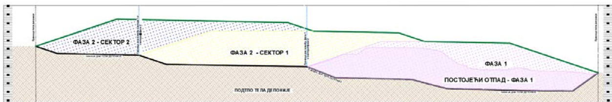
Слика 3.5.4. Подужни пресек кроз депонију - фазе 1 и 2
