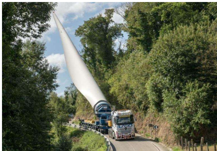
Слика 3.5. Изглед специјализованог возила за превоз лопатица - „ blade lifter “
