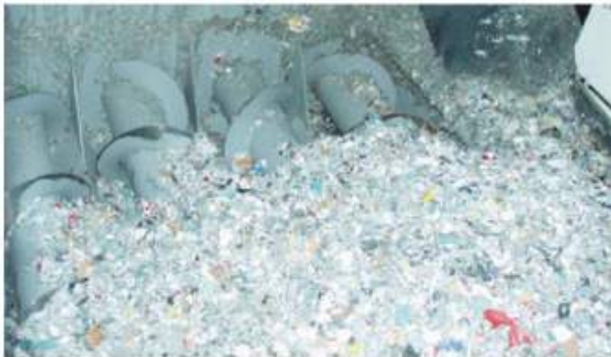
Слика бр. 9: Изглед пужног транспортера у истоварној станици
