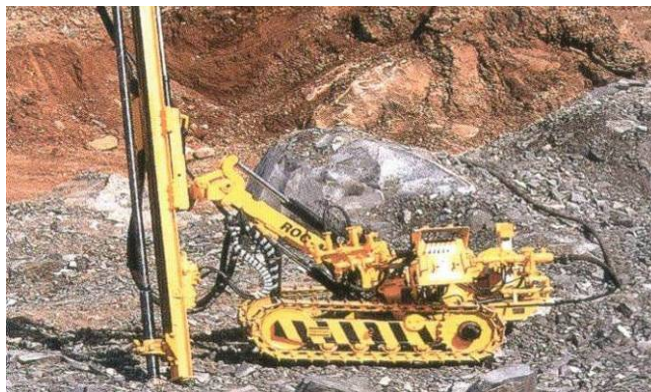
Slika 10. Izgled pneumatske bušilice „ROC 203“
