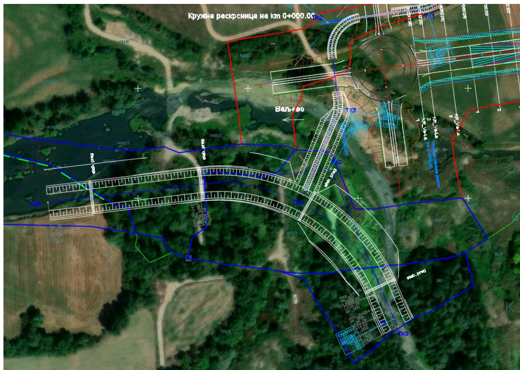
Слика 31 - Приказ регулације реке Колубаре на локацији 1
