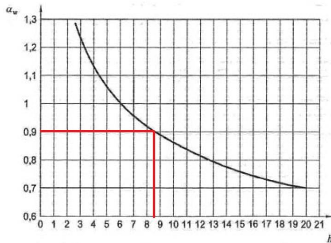
Слика 2. Фактор \alpha_w за утицај просечне унутрашње висине на w фактор
