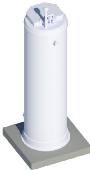
Слика 25. Црпна станица са темељном плочом димензија 2.5x2.5x0.3m
