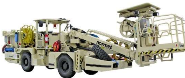
Slika 4.4.22. Vozilo za transport i punjenje bušotina eksplozivom tipa Charmec MF 605 DA
