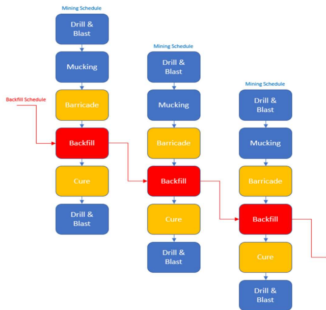
Slika 4.7.6. Ciklus zasipavanja. Zasipavanje je integrisano u raspored izrada barikada i očvščavanja zasipa kao i u rasporedu zastoja u otkopavanju.
