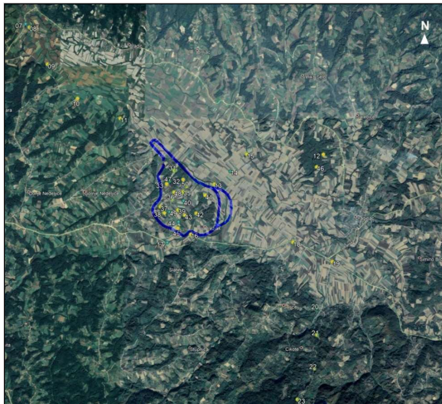
Slika 4.5. Lokacije uzorkovanja na području projekta 'Jadar': ● - kompozitni uzorci zemljišta ● - kompozitni uzorci zemljišta (Plavom konturnom linijom prikazano je područje predviđeno za izgradnju rudničkog kompleksa sa pratećim procesnim postrojenjem za preradu minerala)
