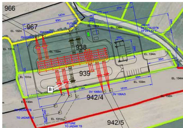
Slika 7.2.4. Razvodno postrojenje 110/35 kV/kV i uklapanje na postojeći dalekovod
