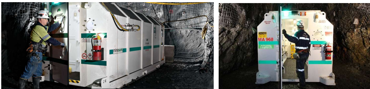
Slika 4.10.2. Izgled pomoćnih, mobilnih stanica za spasavanje
