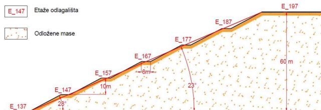
Slika 5.4.1. Konstruktivni elementi spoljašnjeg odlagališta
