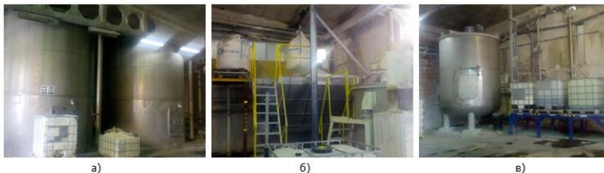
Слика 20. Производно складишни објекат за припрему премаза (а) танкови са Litex-ом, б) дисперговање Каолина, в) складиштење диспергованог Каолина
